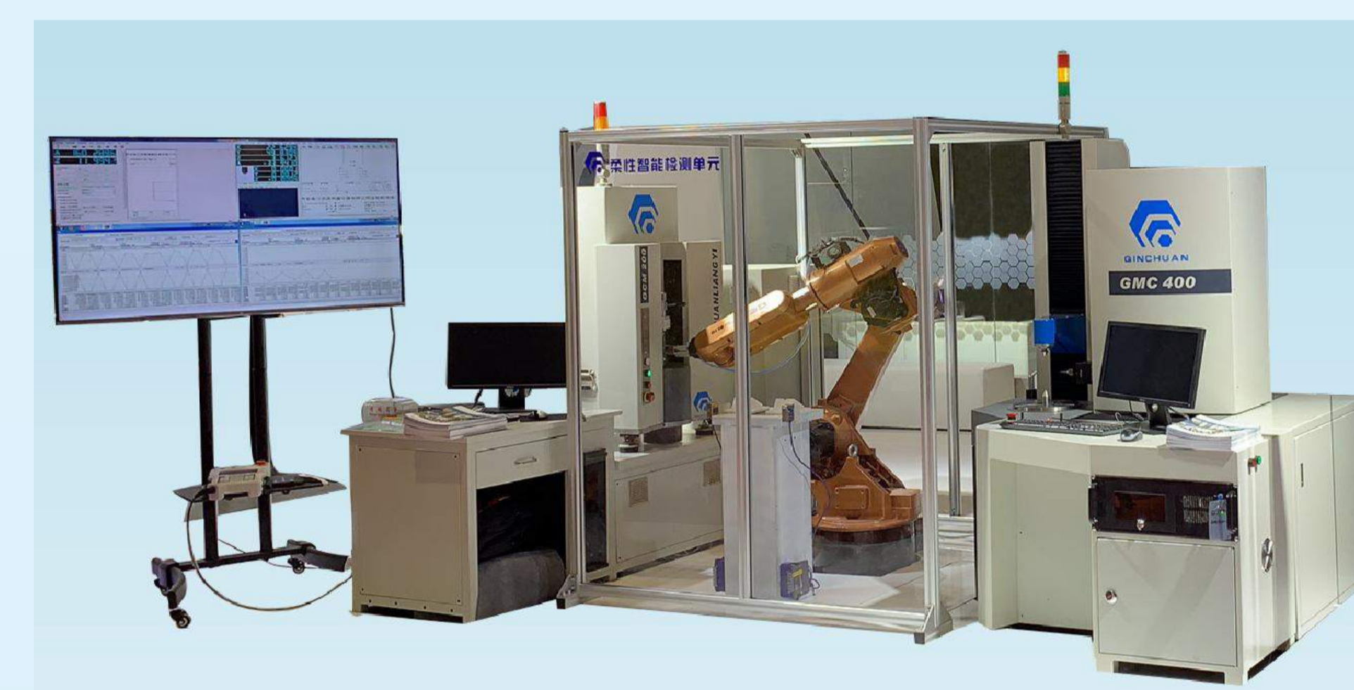
智能产线上柔性检测单元
