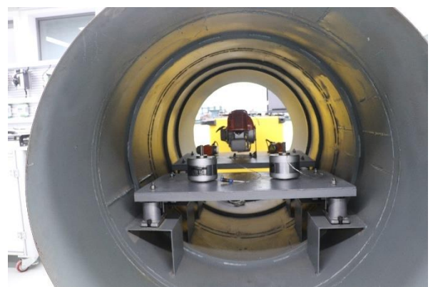
多舱段潜艇结构振动主动控制模拟仿真试验系统
