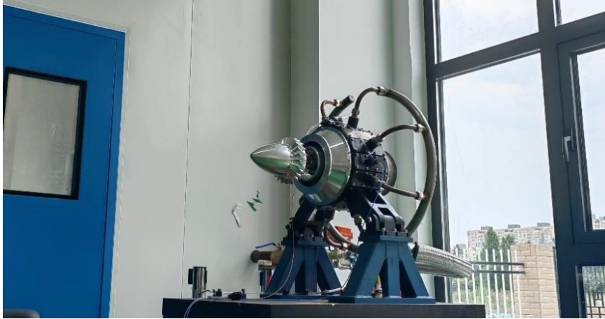
航空发动机涡轮级间混合部件性能仿真平台
