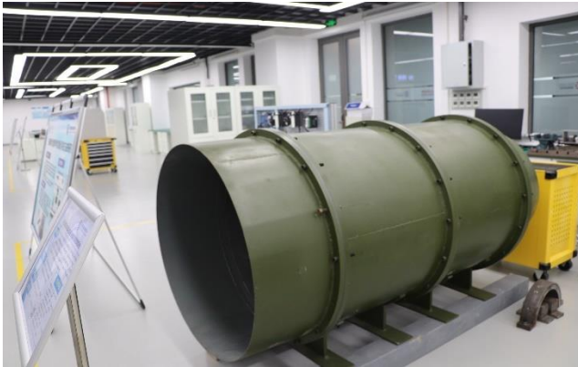
多舱段潜艇结构振动主动控制模拟仿真试验系统
