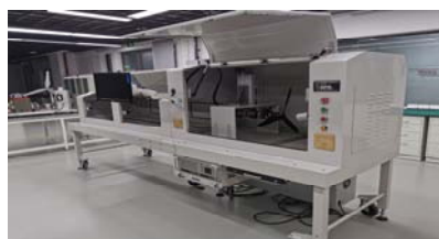
直升机旋翼椎体测量试验台
