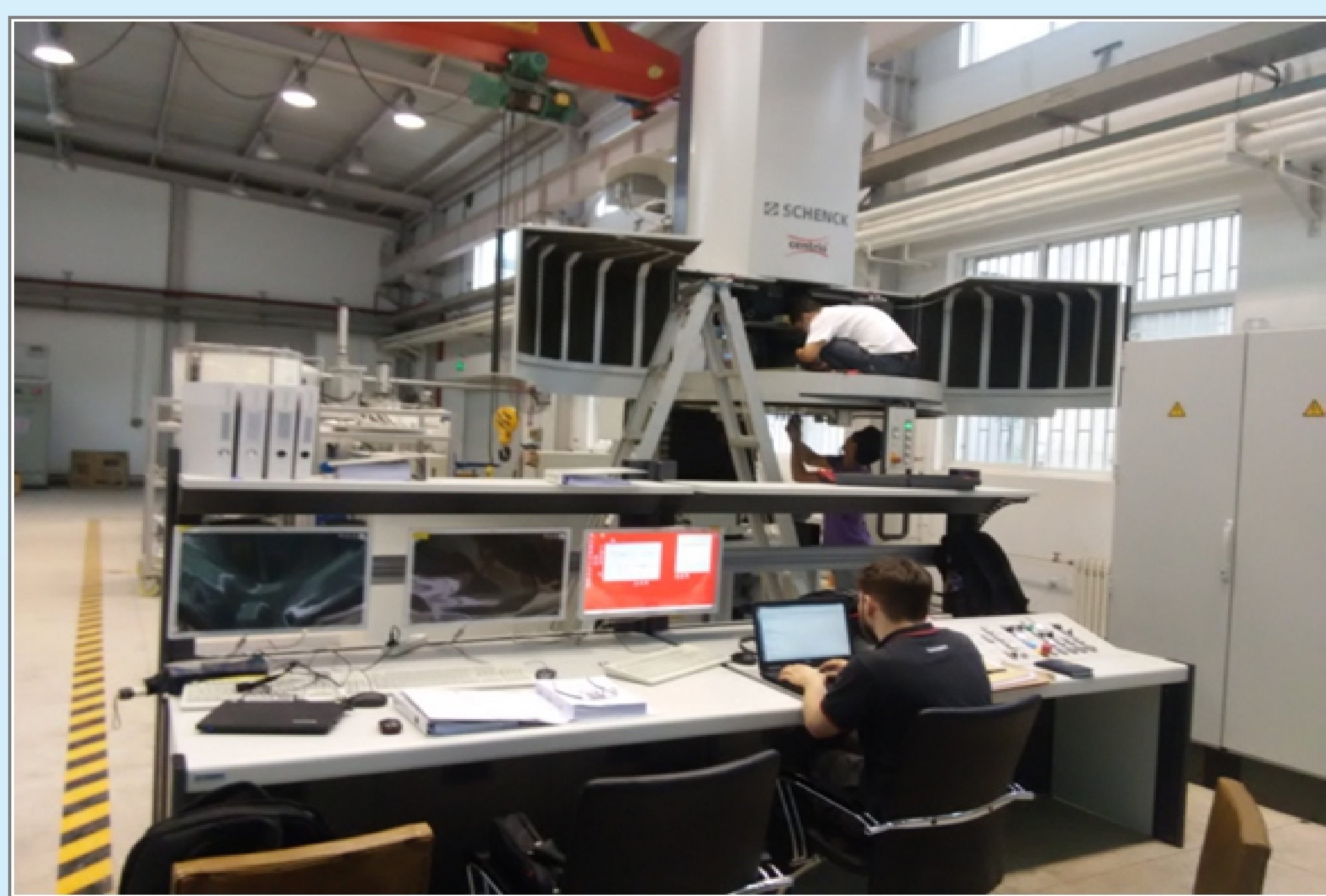
高速转子疲劳强度及极限强度测试平台
